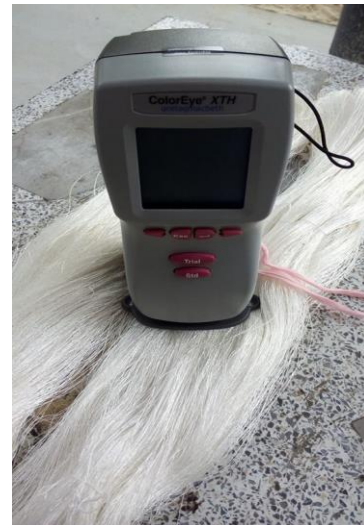
รูปที่ 2 การวัดความขาวของเส้นไหมหลังฟอก ด้วยเครื่องวัดสี (Spectrophotometer)
