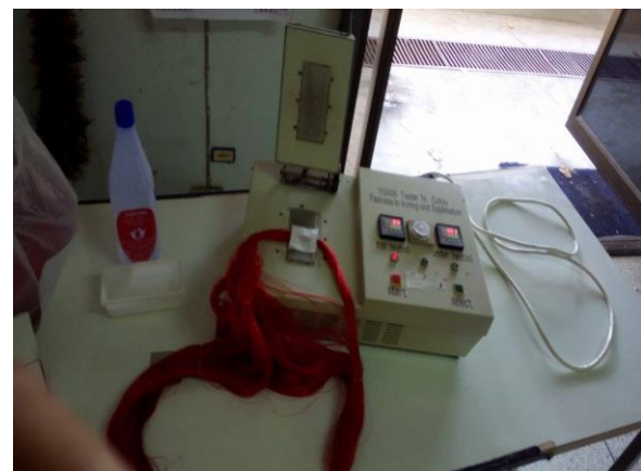
รูปที่ 4 การวัดสีหลังย้อม ด้วยเครื่องทดสอบสีตกจากการกดทับด้วยความร้อน
