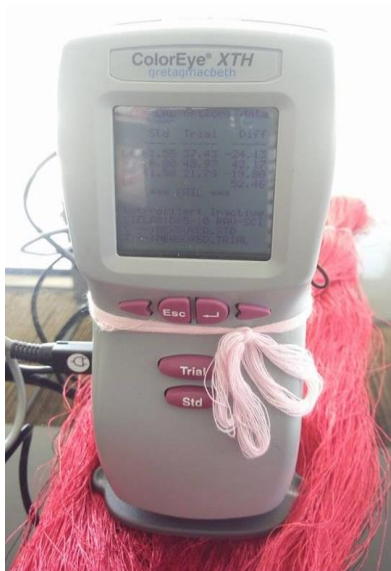
รูปที่ 3 การวัดสีแดงหลังย้อม ด้วยเครื่องวัดสี (Spectrophotometer)
